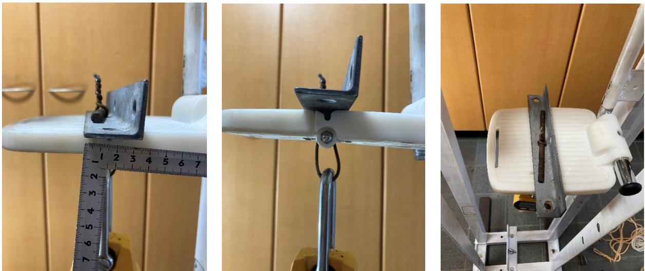
図 3 しなりによるパットのずれを防止するため、幅 30 mm のアングルを用い、スマートフットレストのセンターホールから下方に引き下げる方法により、下方静的荷重試験を行った。
